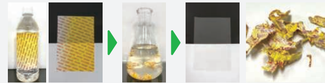
80℃、1.5wt%（濃度）の水酸化ナトリウム水溶液（アルカリ性）で10分攪拌後、水洗いしたもの
